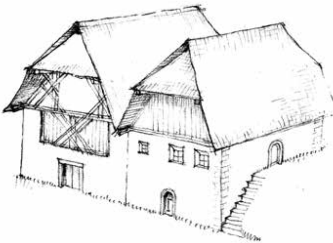
feuer- und futterhaus traufseitig zusammengebaut
